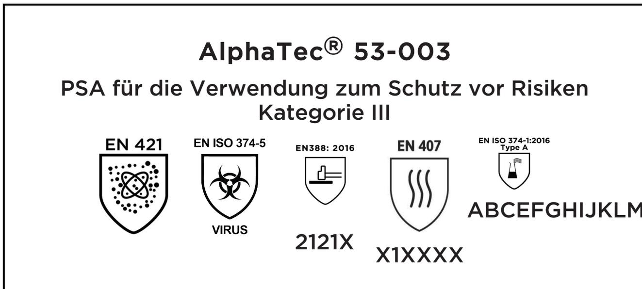
erfüllt die Vorschriften der Verordnung (EU) 2016/425 und der Normen EN 421:2010, EN ISO 374-5:2016, EN 388:2016 +A1:2018, EN407:2020 , EN ISO 374-1:2016 und ist identisch mit der PSA, die der EU-Baumusterprüfung (Modul B, Anhang V der Verordnung) unterliegt; die von der benannten Stelle zugewiesene Zulassungsnummer 032/2024/0136 lautet:
