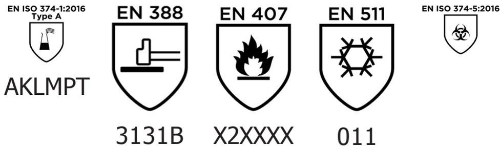
erfüllt die Vorschriften der Verordnung (EU) 2016/425 und der Normen EN ISO 374-1:2016, EN 388:2016, EN 407:2004, EN 420:2003 + A1:2009, EN 511 Kälteschutz, EN ISO 374-5:2016 und ist identisch mit der PSA, die der EU-Baumusterprüfung (Modul B, Anhang V der Verordnung) unterliegt; die von der benannten Stelle zugewiesene Zulassungsnummer 032/2019/0549 lautet:
